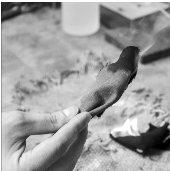
І майже не горить, а лише тліє зразок, оброблений “Феніксом”. Результат підпалу. Тканина обгоріла тільки збоку, але не повністю.
